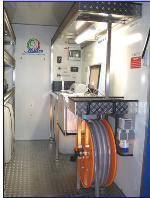
Operatorraum mit Druckprüfgerät, Drucker, VA - Regale mit Schlauchhaspeln, Wassertanks für Hochdruckanlage (optional für Prüfungen nach EN805)
