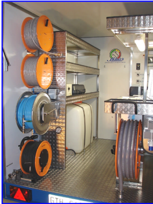
Operatorraum mit Druckprüfgerät, Drucker, VA - Regale mit Schlauchhaspeln, Wassertanks für Hochdruckanlage (optional für Prüfungen nach EN805)
