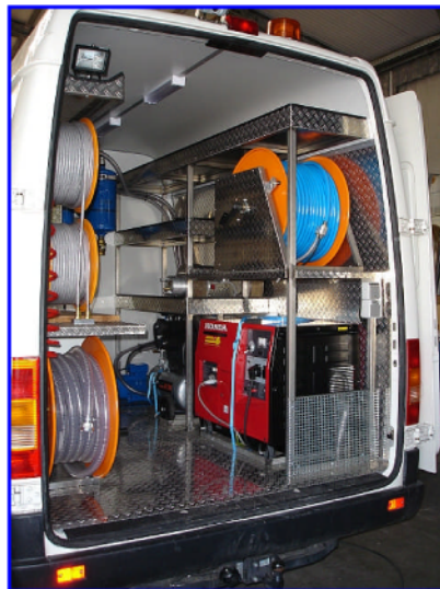
Maschinenraum mit Generator, Kompressor und Verdichter, Schlauchhaspeln und Einbauregale für Blasen und Zubehör
