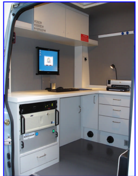
Operatorraum mit Druckprüfgerät, Industrie-PC + TFT-Display, Drucker und div. Ablagen
