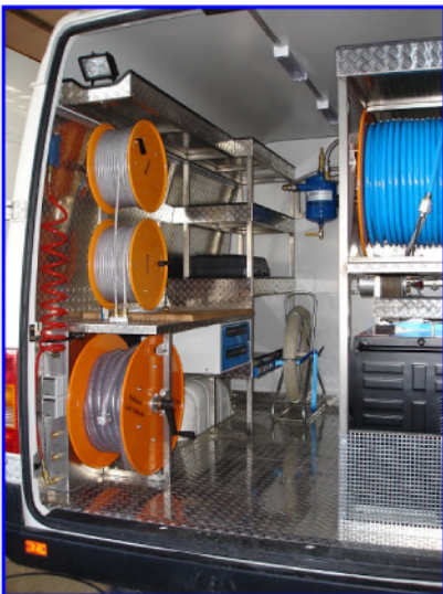
Maschinenraum mit Generator, Kompressor und Verdichter, Schlauchhaspeln und Einbauregale für Blasen und Zubehör
